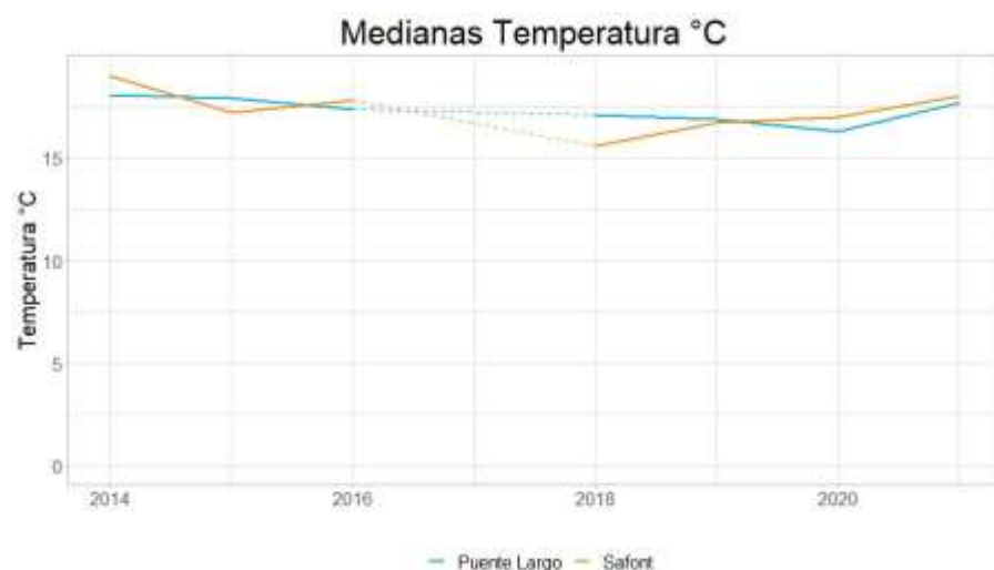
Figura 22. Comparación de las medianas anuales de la temperatura (° C) en las estaciones de Puente Largo y de Safont de la Red SAICA (2014-2021)
