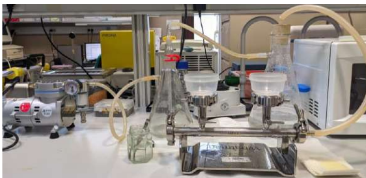
Figura 3. Equipo de filtración.
