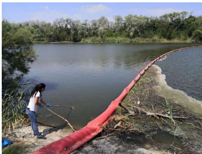
Figura 2. Ejemplo de recogida de muestra con pértiga (Punto de muestreo DET19).
